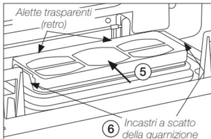
Controllare che gli incastrati a scatto della guarnizione siano inseriti nelle cavità laterali (6) del telaio del filtro. Chiudere il coperchio premendo su entrambi gli spigoli superiori finché non scatta.
