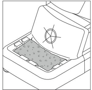
最柔和的清洁方式。使用时请用蒸馏水保持海绵湿润，以避免焊嘴磨损。
