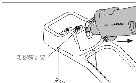
将装有吸锡嘴的手柄放入取装凹槽中，并向外拉动工具，以取下焊嘴。
