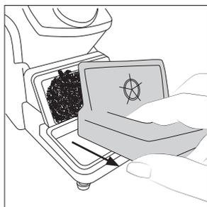
将刮锡垫拉出以拆下。
