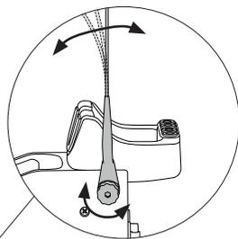
集线器采用柔性设计，可在焊接过程随工具移动而摆动。
