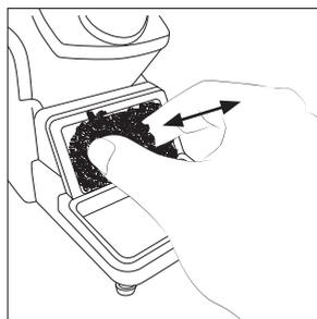
黄铜丝清洁球破损时，请更换新的。将刮锡垫放回原位，如有需要，可进行更换。
