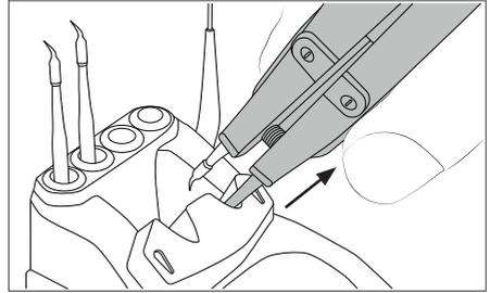
将烙铁头插入取装槽中，并向外拉动镊夹，以取下烙铁头。
