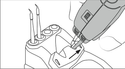
将烙铁头插入取装槽中，并向外拉动镊夹，以取下烙铁头。
