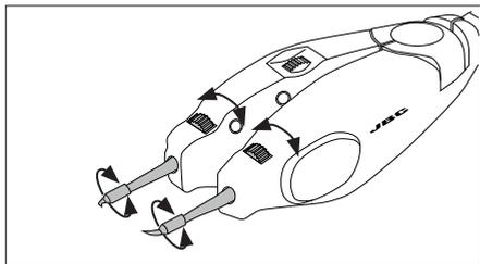
根据需要轻轻旋转旋转轮子以对齐烙铁头。
