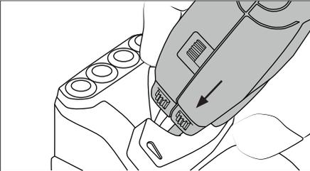
将镊夹放在新烙铁头上方，向下按压。
