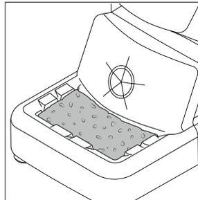
最柔和的清洁方式。使用时请用蒸馏水保持海绵湿润，以避免焊嘴磨损。
