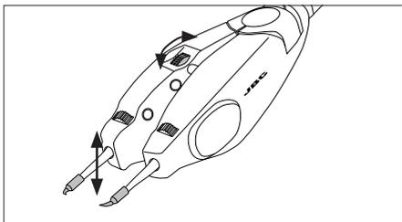
按紧镊夹，后部轮子可让烙铁头在垂直方向均匀对齐。
